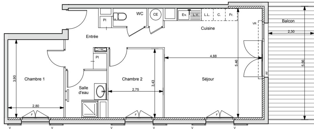
Hauteur sous plafond des pièces principales : 2,40 m sauf zone faux-plafonds et soffite mentionnée sur les plans
